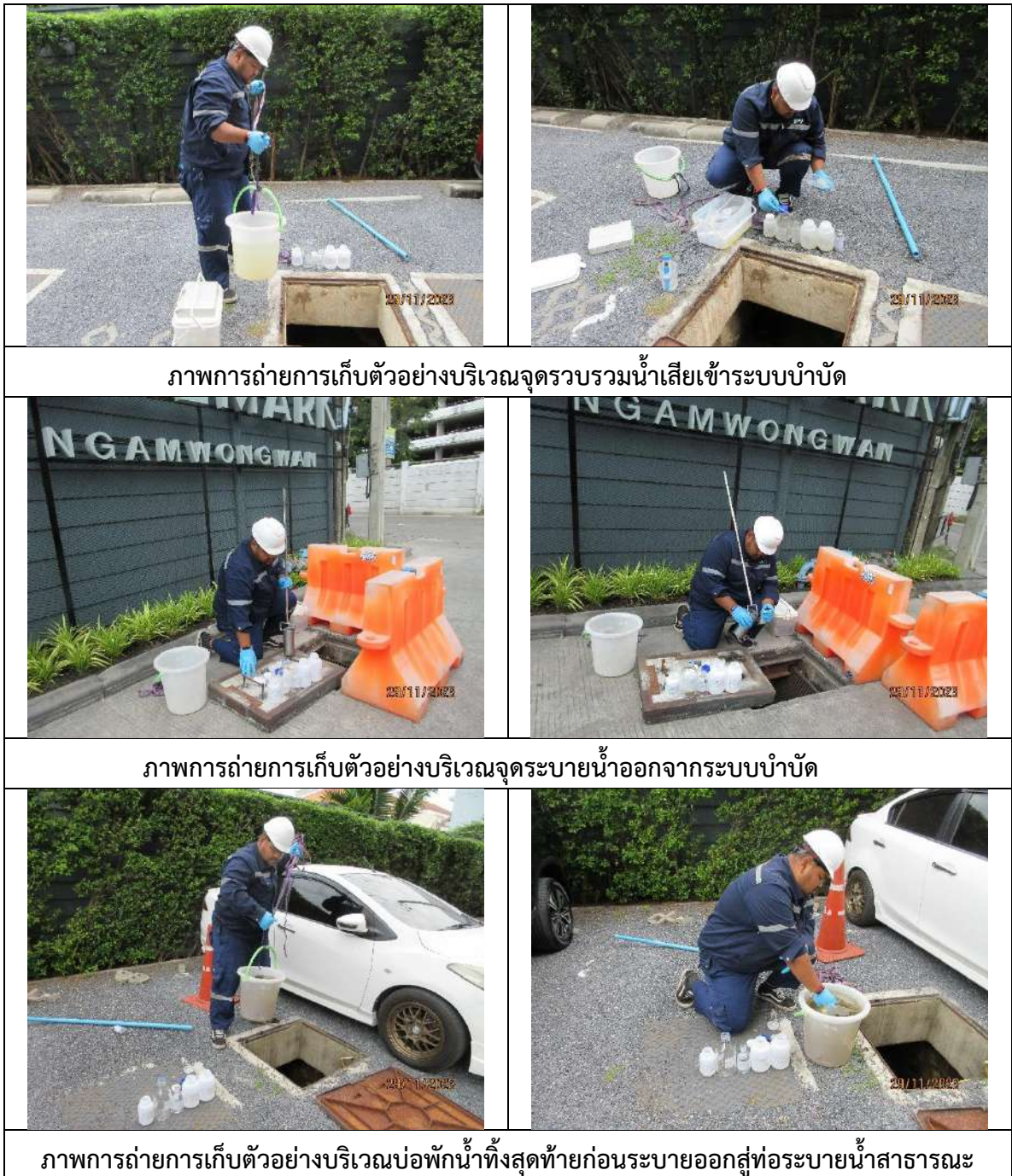
รูปที่ 3.6-1 ภาพถ่ายภาพเก็บตัวอย่างคุณภาพน้ำจากระบบบำบัดน้ำเสีย
